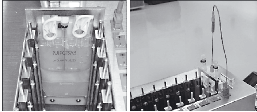
III.24 : Mise en place du Celsius® Pak et connexion du thermocouple
