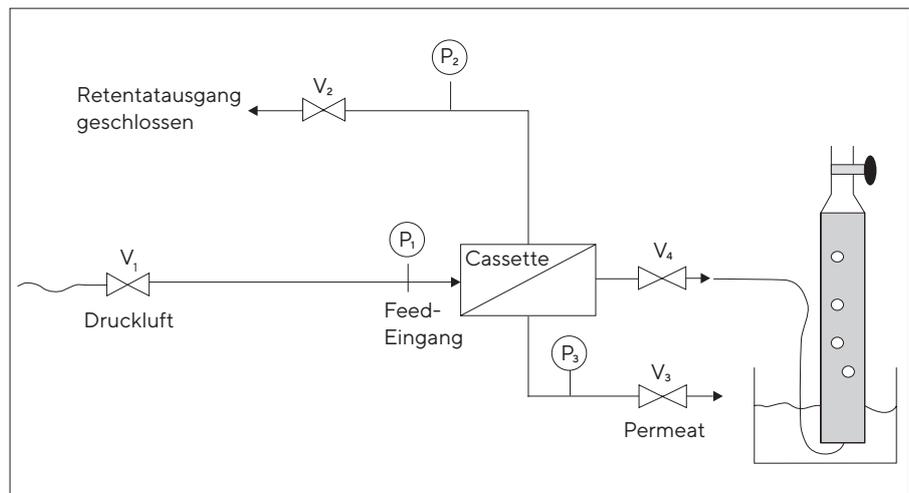
Abb. 13: Systemaufbau für manuellen Integritätstest.  $V_1$ - $V_3$ : Ventile;  $P_1$ - $P_3$ : Manometer
