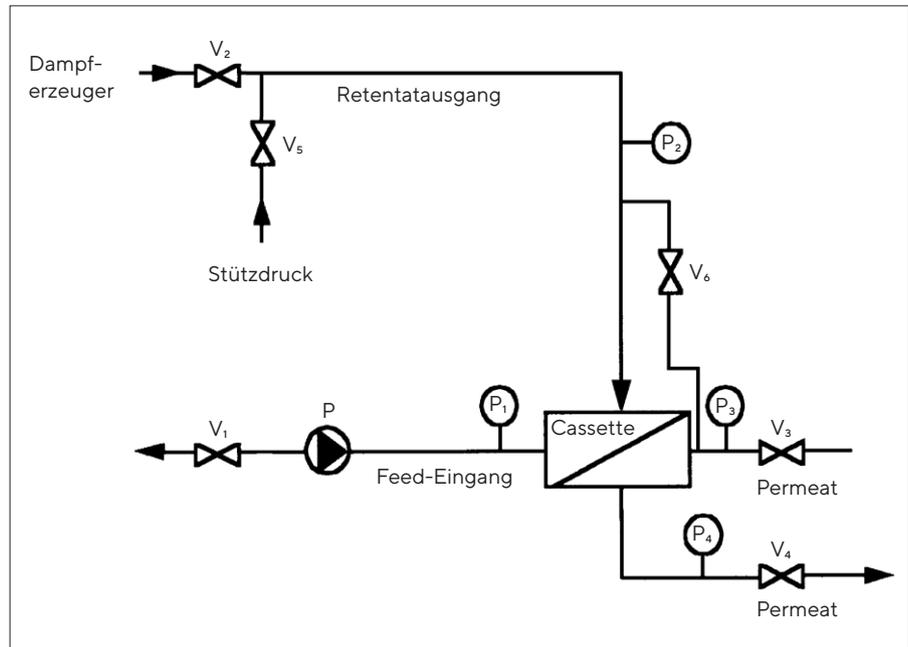
Abb.18: Aufbau der Anlage für die In-Line-Bedampfung von Ultrafiltrations-Cassetten.
