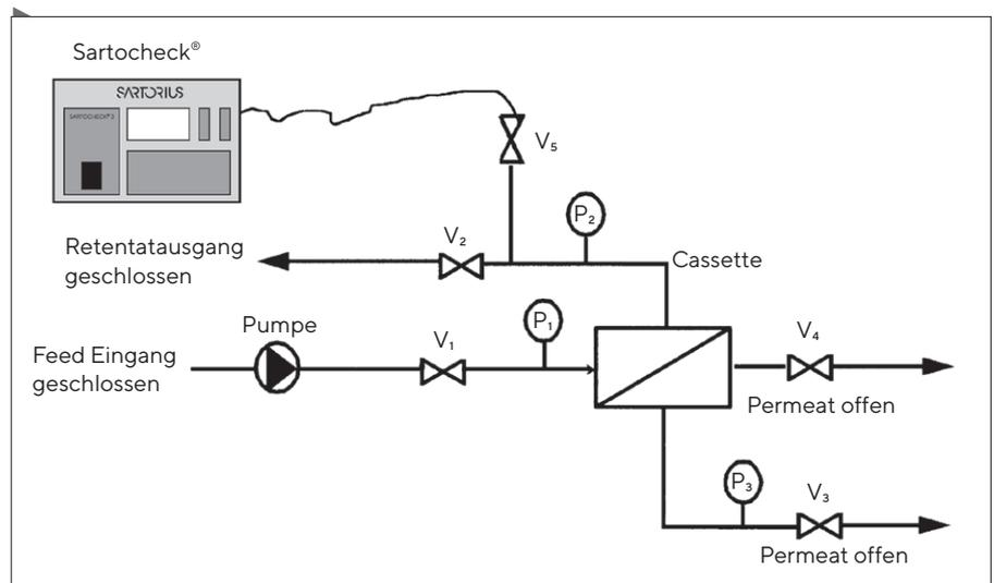
Abb. 14: Systemaufbau für den automatischen Integritätstest.
