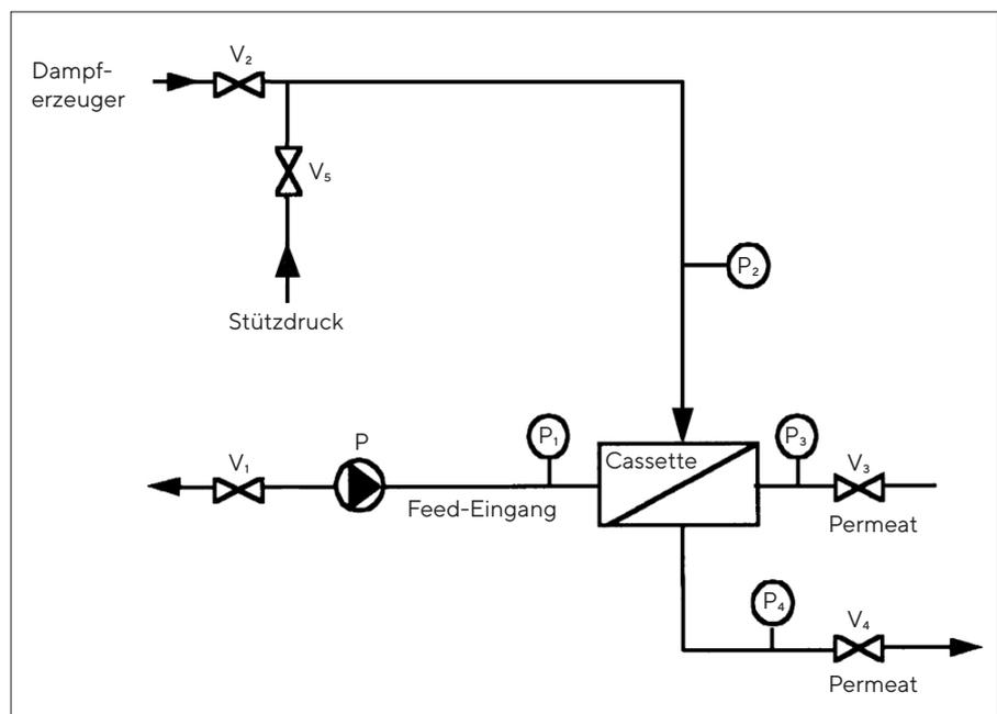
Abb.15: Aufbau der Anlage für die In-Line-Bedampfung von Mikrofiltrations-Cassetten.
