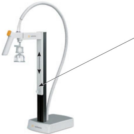
Um sicherzustellen, dass der Schlitten dauerhaft in der gewünschten Position verbleibt, lässt sich der Schlitten fest arretieren.
